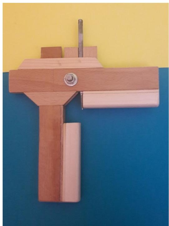
Rechts neben dem Messer, zeigt das innen liegende Holz einen Spalt, so wie alle drei mittleren Hölzer, er dient dazu, Messer und Querschiene, bei entspannter Schraube, bewegen zu können.
