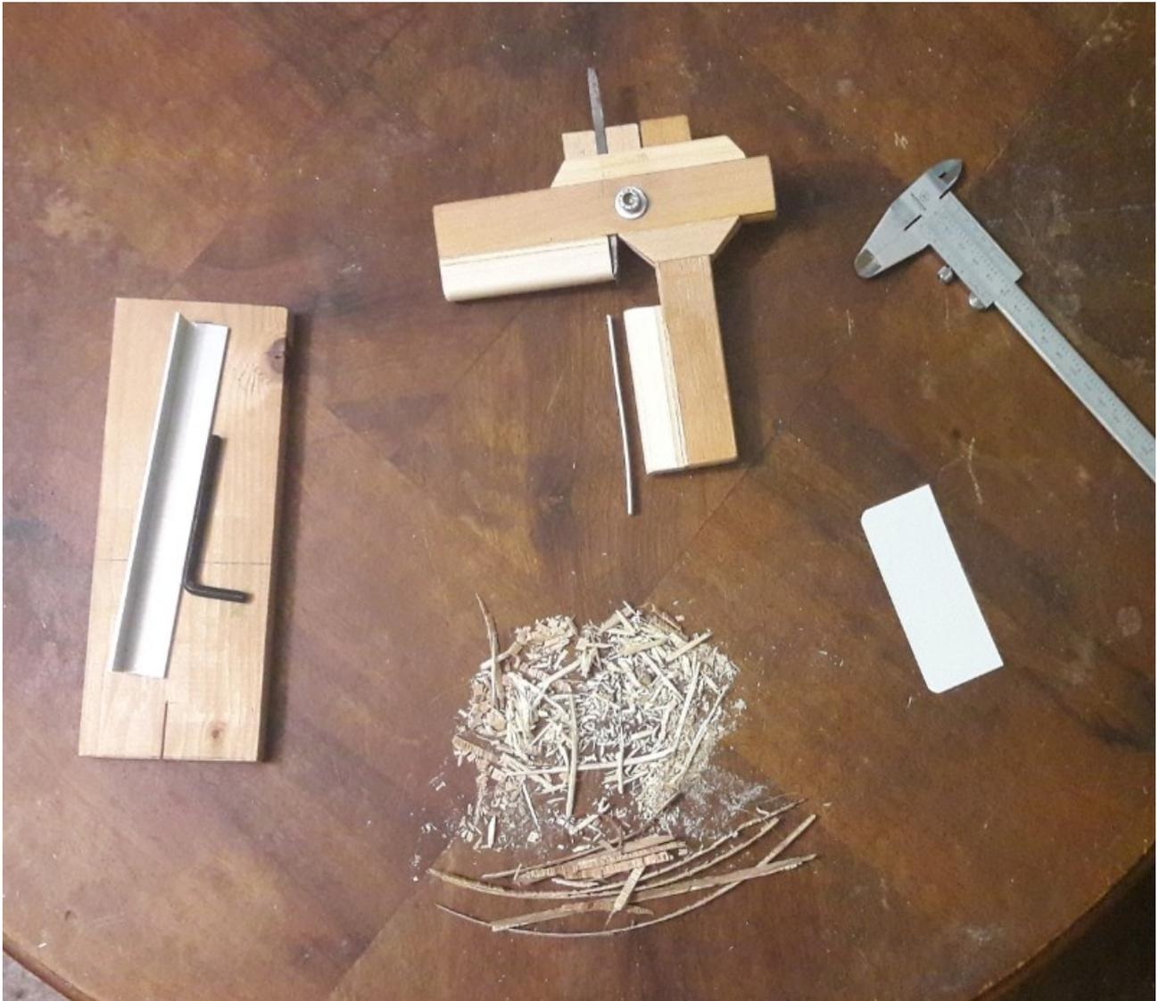
***Alle guten Dinge sind Drei. Die III. Version meines selbst gebauten Purfling Cutters funktioniert !***
