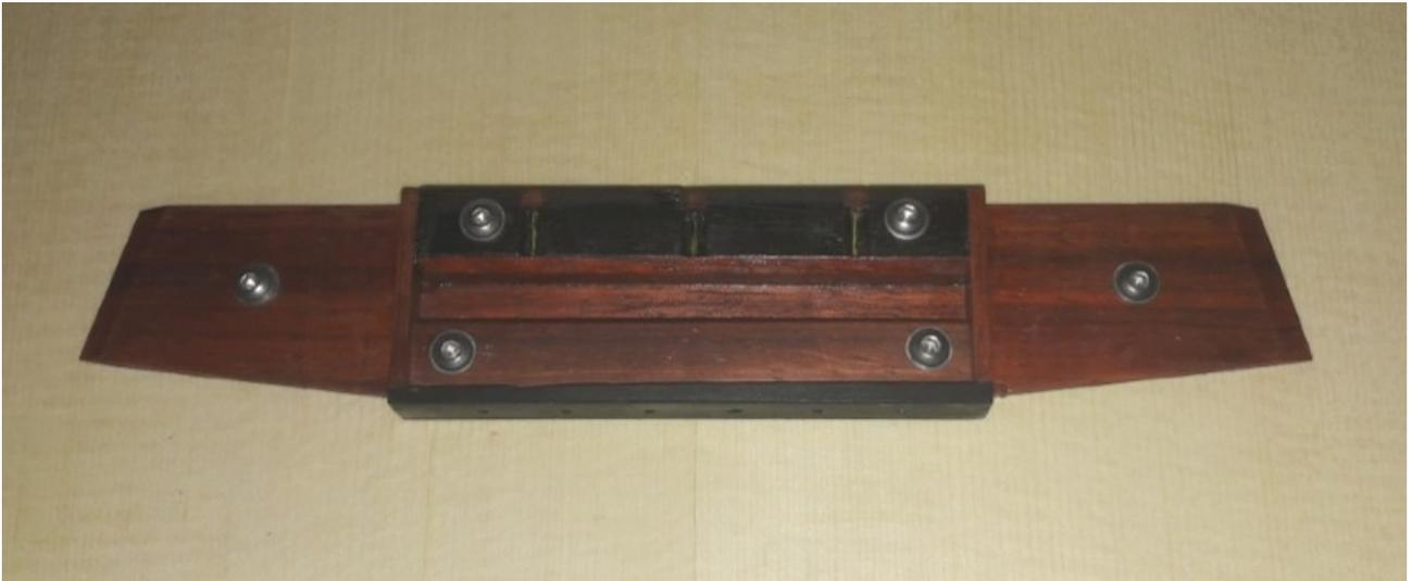
An den richtigen Stellen über den Steg verteilt - dort wo die Fixierpins angeordnet sind, die die spätere Stabilität des Stegs gewährleisten sollen - werden Maschinenschrauben unter der Decke mit Muttern gekontert. Dies garantiert einen gleichmäßig verteilten hohen Druck über den gesamten Steg. Die beiden Enden habe ich natürlich mit einem größeren Holz abgedeckt, damit sich der Druck auf den gesamten Flügel möglichst gleichmäßig verteilt.
