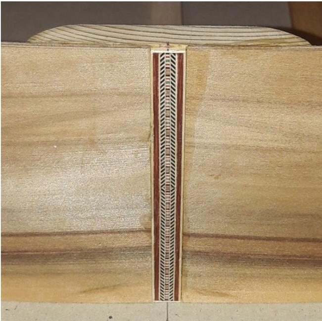
Der Unterklotz, die beiden Zargen und der Zwickel, alles noch ungeschliffen.
