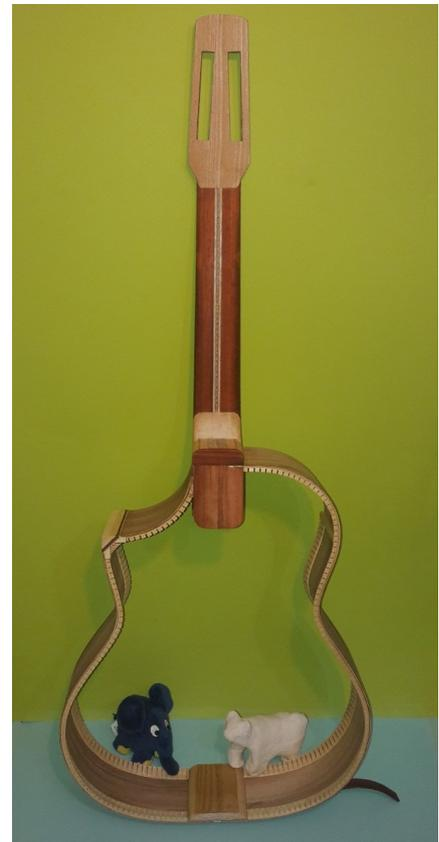
Was der Gitarre durch den Cut an Volumen fehlt, habe ich durch den unsymmetrischen Aufbau im Diskant ausgeglichen. Etwas breiter, mit leicht hängendem Unterbauch. Siehe rechtes Bild.
