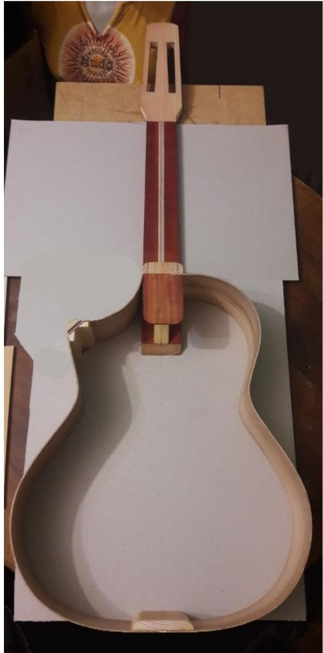
Wer genau hinschaut, sieht am Oberbug des Bass, dort wo er in den Halsfuß ragt eine kleine Ungenauigkeit im Winkel der Zarge und die Ausbuchtung am Unterbug des Diskant ist etwas zu groß. Beides wird bereinigt, in dem ein entsprechend langer Spannstab vor dem Aufschachteln in die Länge eingesteckt wird. Der Zargekranz wird damit um 12 mm gestreckt.
