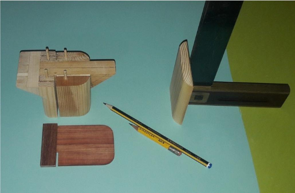
Der rundum geschliffene Halsfuß, mit dem innen liegenden Oberklotz. Spanischer Bauart!
