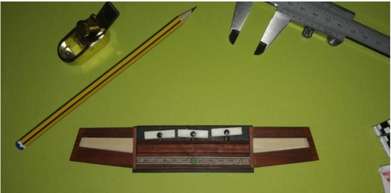
Der Steg besteht insgesamt, aus sage und schreibe - ohne die erforderlichen Fixierpins - 27 einzelnen Teilen. Rechnet man die unbedingt erforderlichen Fixierpins dazu, sind es 33 Einzelteile.
