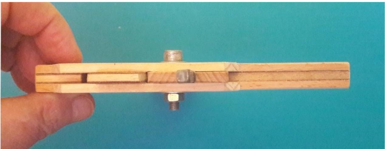
Das Messer, aus einem alten Stechbeitel zurechtgefeilt, lässt sich bei entspannter Schraube, für die Schnitttiefe nach oben und unten bewegen. Der senkrechte Griff, lässt sich im waagerechten Schlitten - für den Abstand zur Kante - nach links und rechts bewegen.
