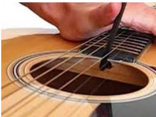
Über das SchallLoch ist der für Flamenco-Gitarren eher unübliche SpannStab (Tross Rod) zur Einstellung der HalsKrümmung via Inbus zu erreichen. So ist auch das aufziehen von Tomastik StahlSaiten für KonzertGitarren eine Überlegung wert.
