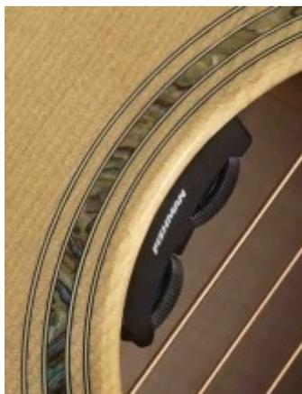
Was in der Darstellung noch fehlt, ist, den hervorragenden Vorverstärker **Fishman Sonitone** zu zeigen. Im Inneren der Gitarre angebracht unterbricht er einem nicht das Bild der Zarge, fällt nicht auf und lässt sich bequem durchs SchallLoch bedienen.
